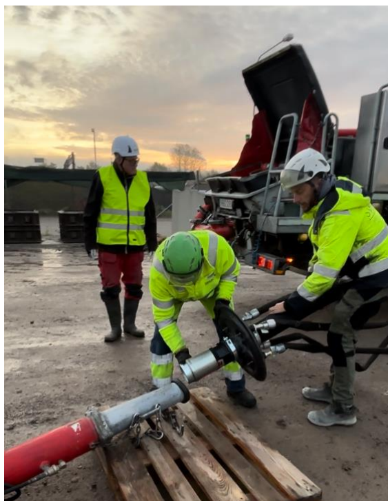
Bild 6. Montering och demontering av pumpslang med robotmodul kan likställas vid att byta den nedre pumpslangen.
