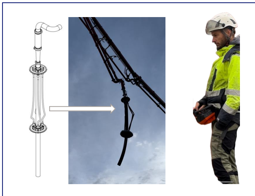
Bild 2. Fjärrstyrd pumpslangsprototyp version 2. El och tryckluft kan kopplas direkt till kranen och fjärrstyrs via joysticker. Mekanikkomponenterna med en övre och nedre fästning har bytts ut till lättviktskomponenter.
